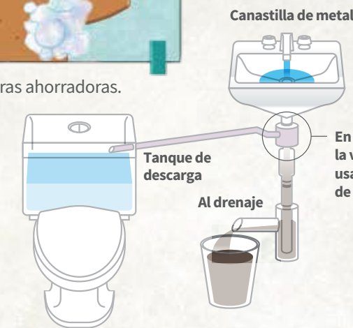
Sistema de reúso de agua residual.
